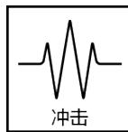
**机械冲击测试Ea和CAF2656:** EN 60068-2-27 (2009)。尖峰加速：50G。时长：11ms。脉冲波形：半正弦波。
