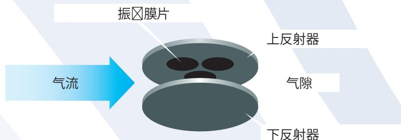
传感器的工作原理是在传感器的测量腔内产生共振超声波信号。 =气流的运动通过测量风通过测量腔时所产生的超声波信号的相位变化来获得。每台传感器均具有三个呈等边三角形排列的换能器。任意一对发射与接收换能器之间的净相位差是该换能器对之间沿轴线方向气流的参考值。因此，通过对三对换能器对的测量，可以测得沿三角形各边方向的气流分向量。合并这些向量即可得出气流的整体速度和方向。传感器使用复杂的信号处理和数据分析，并进行一系列多次测量行为，以计算出常规的风向读数。传感器会针对气流的温度、压力和湿度进行自动补偿。狭小空间内的强共振声波提供了易于测量的强信号。
